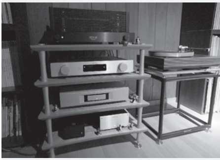
手前ラック2段目がPHONOMODULE。4段目の左側が電源部。
